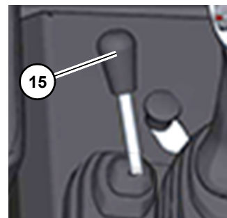
Páka pro otočnou vyklápěcí korbu s vysokým vyklápěním
