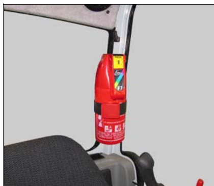
obr.85Hasicí přístroj na sloupku C
