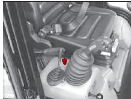
Obr. 48 Spínač tlumení kmitů zvedacího zařízení
