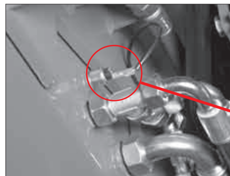
Obr. 79 Snímač teploty hydraulického oleje
