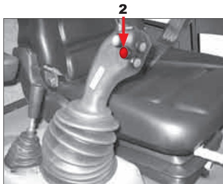
Obr. 50 Spínač elektrické zásuvky u zvedacího zařízení
