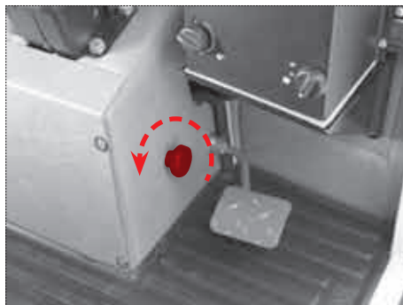
Obr. 30 Změna nastavení po- čtu otáček volnoběhu
