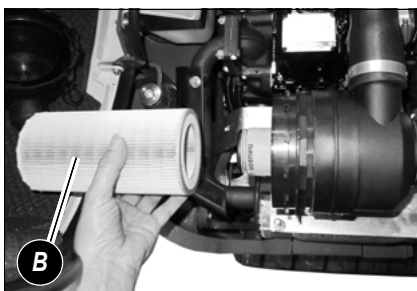
obr. 151: Demontáž vnějšího vzduchového filtru
